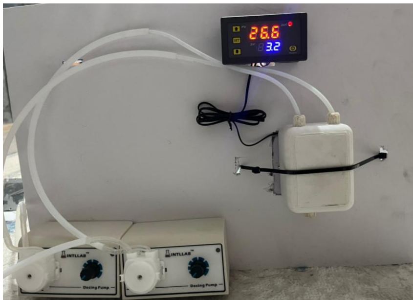
Рисунок 6 — Микрореакторная система без блока охлаждения
